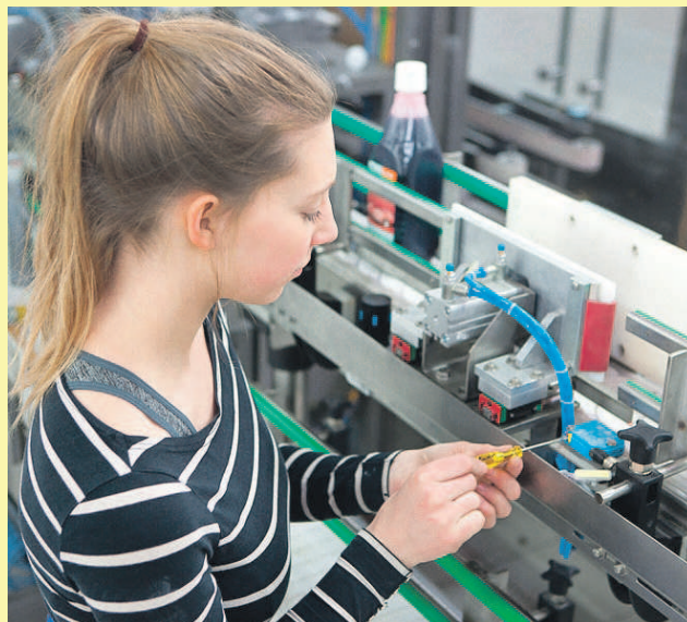
Zunehmend lernen Frauen den Beruf der Mechatronikerin. Hier wird gerade die Lichtschranke eines Produktionsbandes eingestellt. Foto: Berufenet
